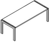
**Fianchi in tubolari di acciaio da mm.100x40 spessore mm.4 colore Grigio Silicio (GS) Grigio Quarzo (GQ) saldati con taglio a 45° a "U" rovesciata, collegati da coppia di travi sottopiano in tubolare di acciaio da mm. 35x35 spessore mm.4**
